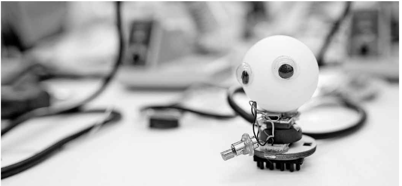
Bristle Bots, also Borsten-Roboter, bestehen aus einem Ping-Pong-Ball und einem Zahnbürstenkopf. Sie haben Leuchtaugen und ein Motörchen.
